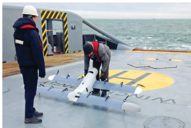
Figuur 1: Eerste versie van de Nederdrone tijdens het testen op het dek van Zr. Ms. Johan de Witt. (Marchand, 2020).
