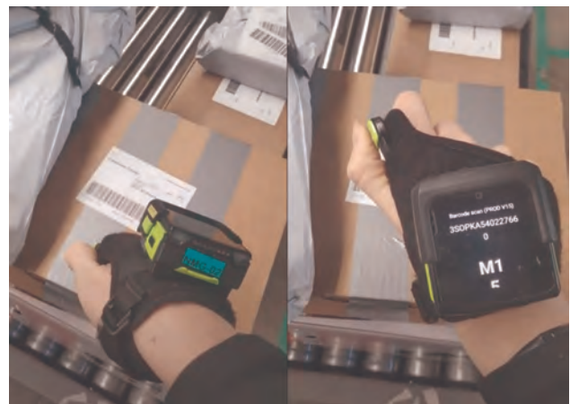
Figuur 3: Foto's van de proef waarin het model werd uitgetest in een hub voor pakketbezorg. De door het model berekende locatie van de pakketten werd via een scanhandschoen aangegeven.
