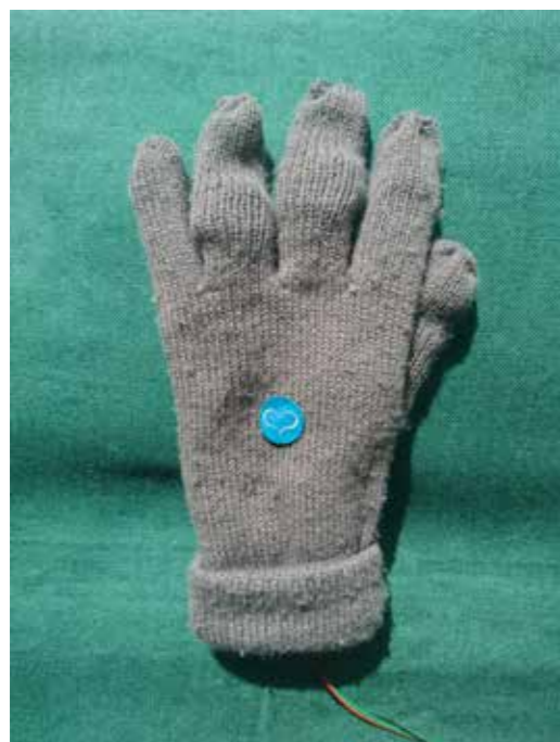
Figuur 2. Handschoen met sensoren voor het meten van temperatuur, hartslag en galvanische huidreactie
