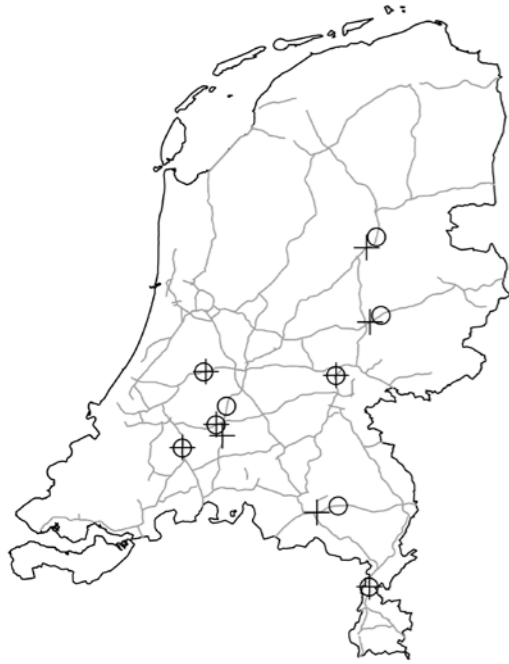
Figuur 1. Locatie van de wegsensoren van het Weigh-in-Motionsensorsysteem; elk van de negen systemen heeft twee stations, één in iedere richting, aangeduid met een plus en een cirkel
