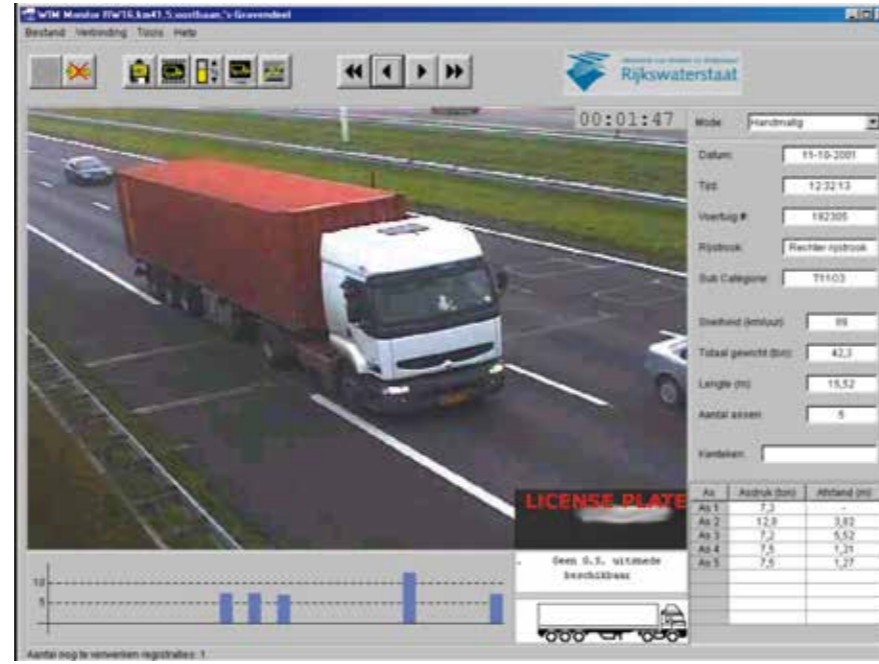
Figuur 2. Weigh-in-Motionsoftware met onder andere het gewicht per as (het kenteken is om privacyredenen vervaagd)
