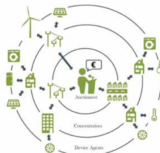
Figuur 1. Visualisatie van het PowerMatcher concept. Bron: < http://flexiblepower.github.io/technology/powermatcher/ >
