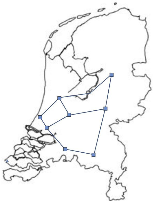
Figuur 3. Toplaag SDH netwerk in Nederland.
