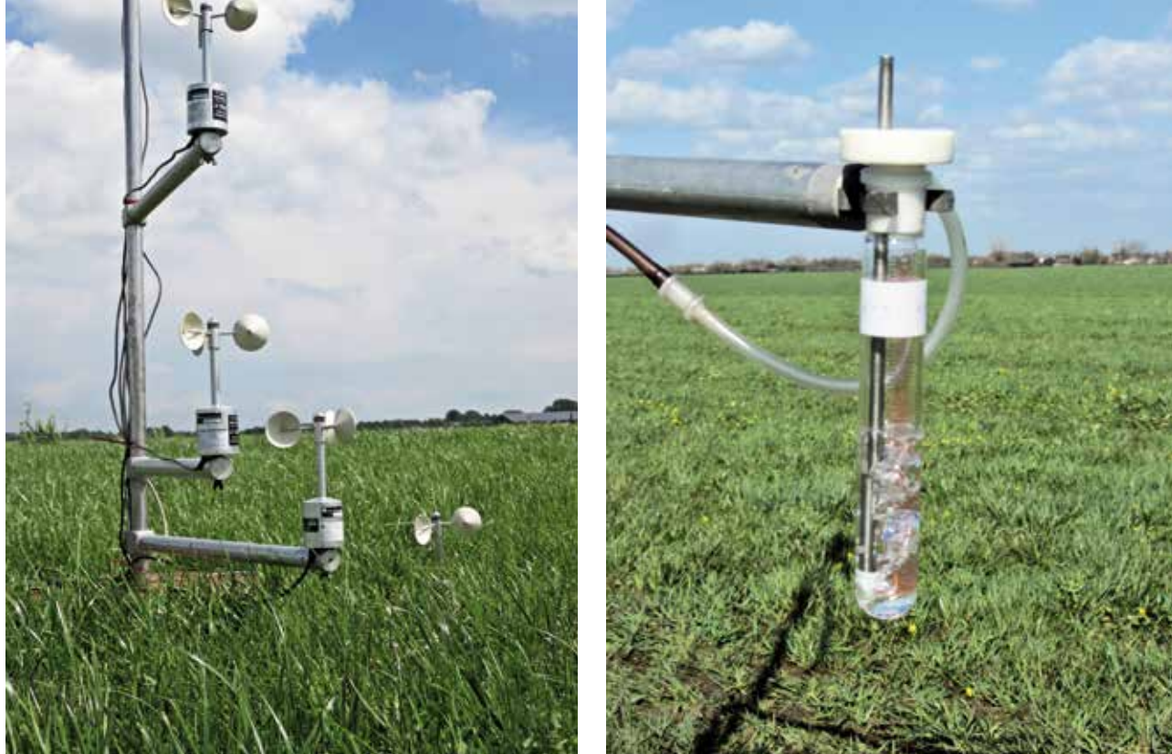
Figuur 1. Links een meetmast met windsnelheidsmeters op verschillende hoogtes, en rechts een zogenaamde Impinger oftewel een flesje met zuur om ammoniak af te vangen
